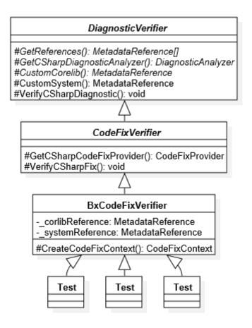
Abbildung 5.2: Vereinfachtes UML Klassendiagramm für die Klasse BxCodeFixVerifier
